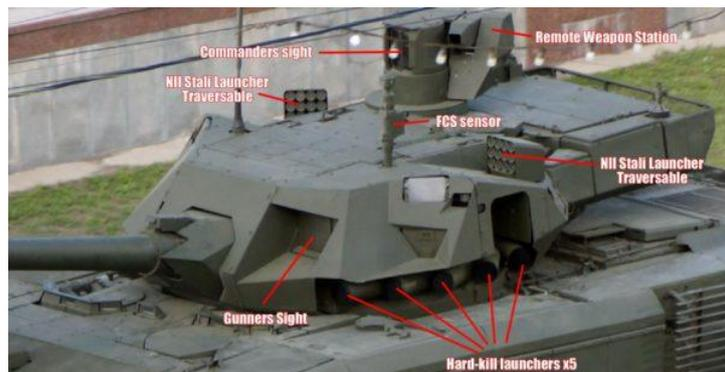
Figure 26 La tourelle téléopérée du T-14 Armata, un concentré de technologie.
